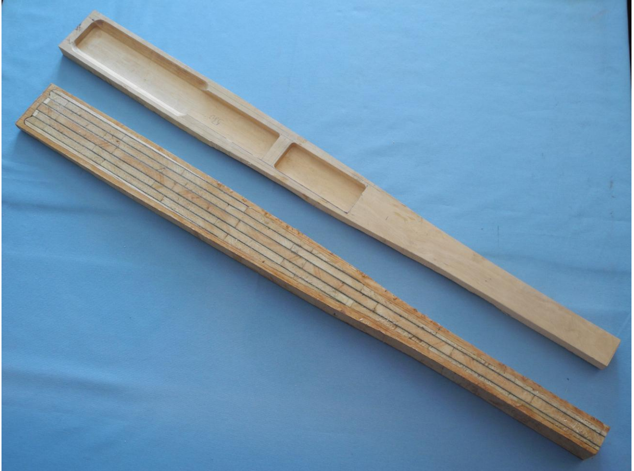
Figur 5 Urfräst överdel, undersidan. att passa in balsa i tillsammans med inlimmat balsalaminat
